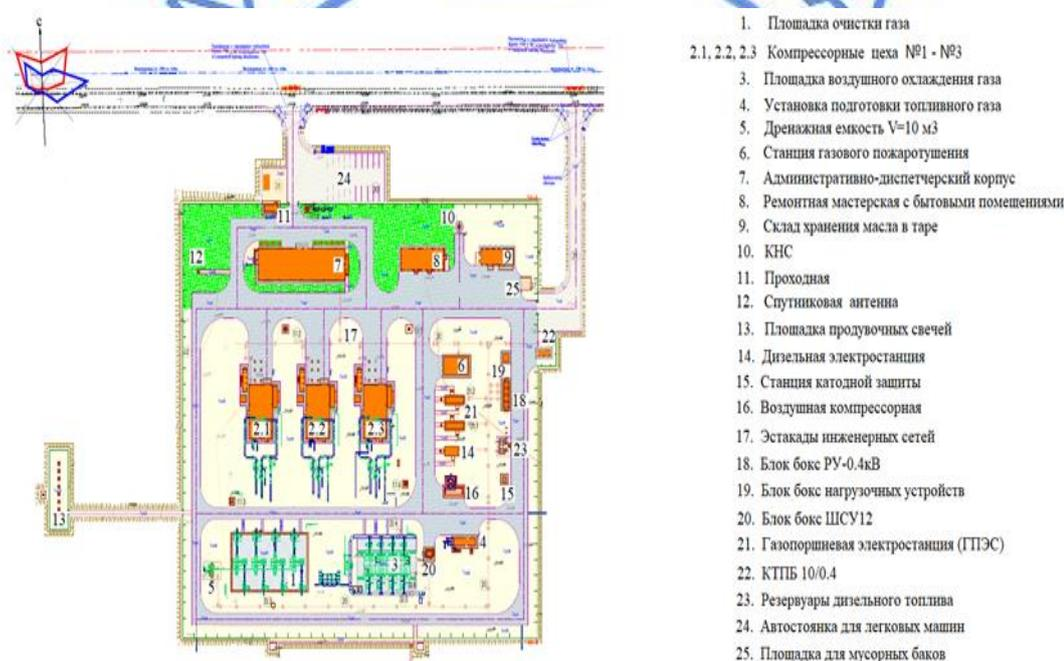
Рис.2. Схема генплана
